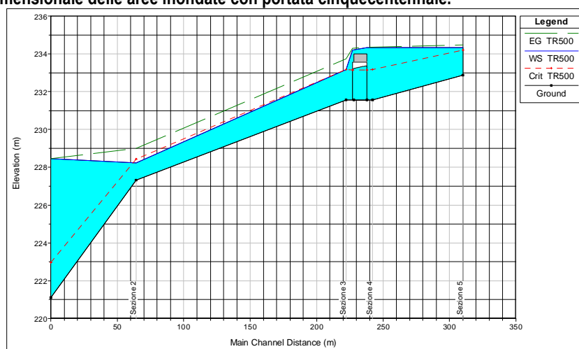
Figura 20 - Profilo longitudinale del tirante di moto permanente associato alla portata cinquecentennale.
